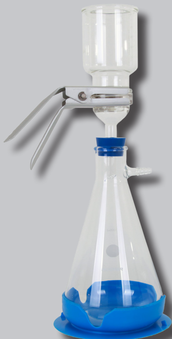
VF6 - silicone stopper
